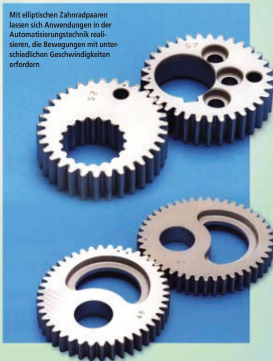
Die Verwendung elliptischer Zahnradpaare ist aufgrund ihrer schwierigen Konstruktion noch wenig verbreitet
